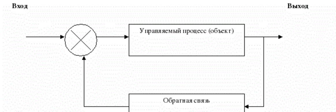
*Рис 1.1* Схема системы управления с наличием обратной связи
